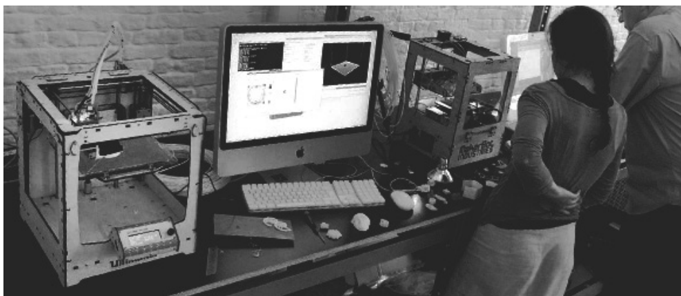
εικ.67. Τρισδιάστατη εκτύπωση - Κατασκευή με 3d printers.
