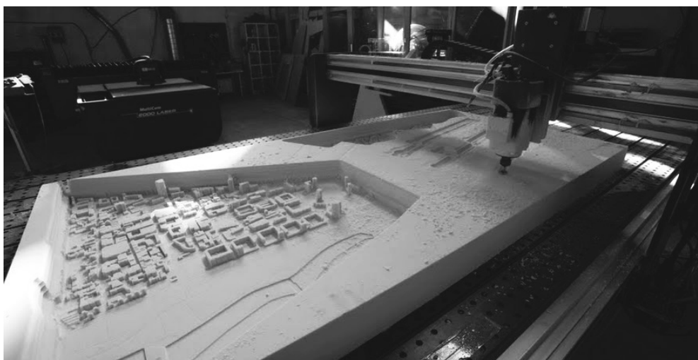
εικ.68. Κατασκευή με CNC (Computerized Numerical Control) εργαλειομηχανές.
